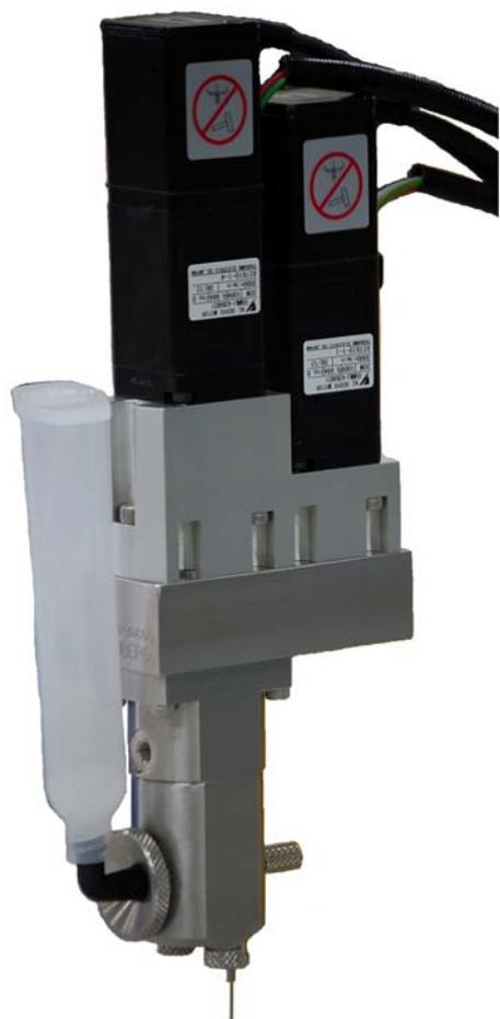
ノイベルクディスペンサ EW 型は、2 台のサーボモータでセラミックプランジャを制御する、容積計量方式の微量精密ディスペンサです。
