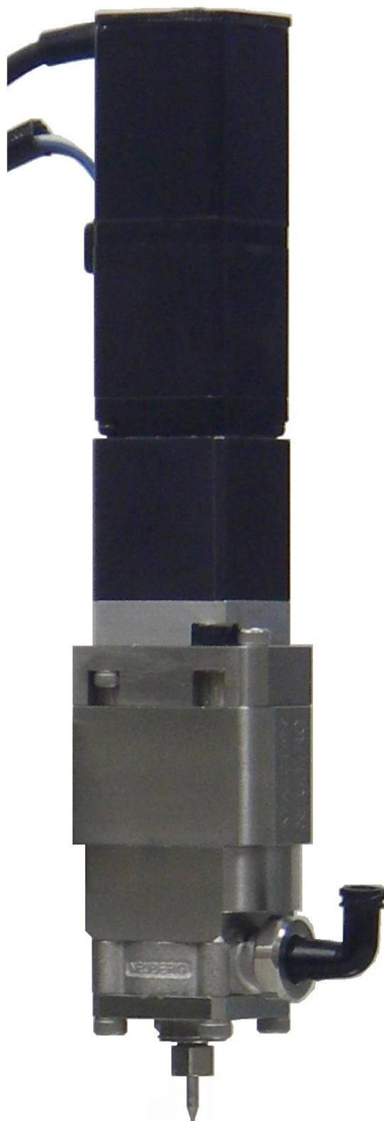
ノイベルクディスペンサKN型は、カムの回転で上下するピンにより1枚のダイアフラムを真っ直ぐに押し微量吐出する、小型軽量のポンプ式ディスペンサです。ダイアフラム方式なので外部漏れは無く、フィルター入りの液など、接液材質が限定される液の充填に特性を発揮します。
