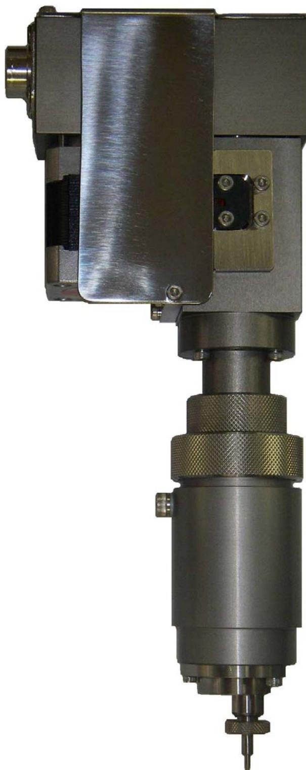
ノイベルクディスペンサLC型は、面バルブと1本のプランジャでポンプを構成したディスペンサです。液中式ディスペンサで、特に精密な線引きに適しています。
