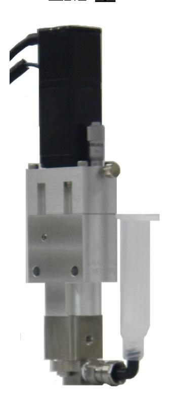
ノイベルクディスペンサ L M型は、面バルブと 1本のプランジャでポンプを構成したディスペンサです。 駆動軸 1 回転で 1 滴毎吐出し制御モータ駆動なので、長期にわたり一定量、速度制御を行いながら吐出する 用途に適しています。 L M型には、制御モータが 2 5 角で小型軽量の L M A と、 4 0 角で 1 回の吐出量が 最大 5 0  $\mu$   $\ell$   $\ell$  まで対応できる L M B があります。
