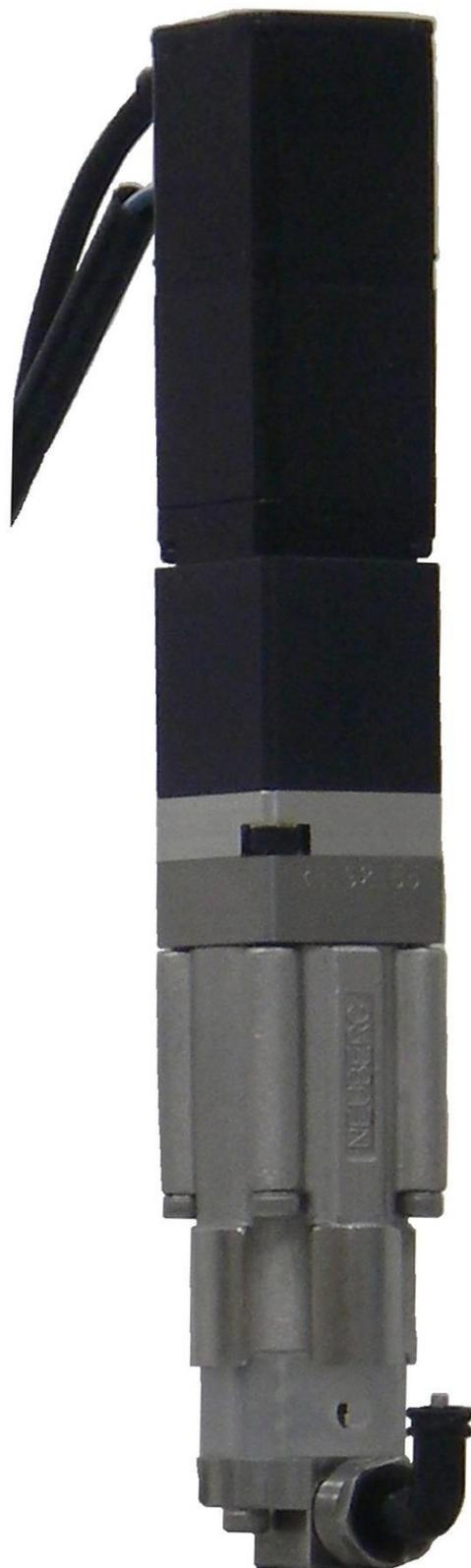
ノイベルクディスペンサRN型は、中粘度以下の液でシリンジバレルも使用でき、駆動軸の回転に伴って吸入と吐出を同時に行う連続吐出式ディスペンサです。制御モータは、25角を使用し、ディスペンサから直接吐出する直結ノズル型の小型軽量タイプです。
