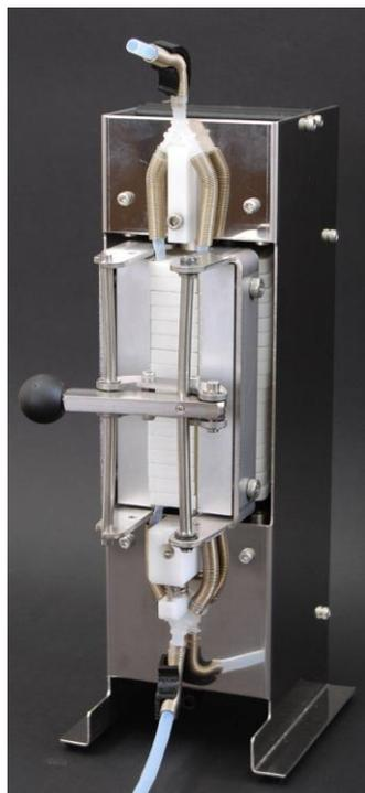
ストレートチューブポンプは、2本のチューブの間を往復する複数のフィンガが作るぜん動運動で、液体を送るチューブポンプです。フィンガを改良して、使用可能なチューブが多くなりました。ストレートチューブポンプの特徴はそのままに、フッ素樹脂チューブなどの硬いチューブ用にも使用できます。圧縮空気で作動するステッピングエアモータ(特許出願中)で駆動しているので、防爆の必要な環境でも使用できます。
