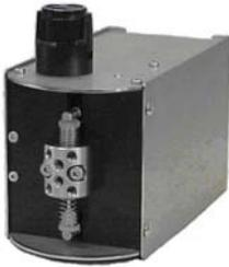
ノイベルクディスペンサVM型は、2本のプランジャとプランジャバレルによって、吐出完了時、ポンプ室内の残液のない独特の構造によって精度を維持する微量精密充填用のディスペンサです。
